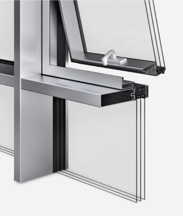
EFS 40은 커튼월 전용 창 EWS 60 SG와의 결합을 통해 효율적인 실내 공기질 순환이 가능합니다. 특히, EWS 60 SG는 기존 커튼월 전용 창과는 달리 프레임 내 폴리아미드 바를 삽입하여 도어와 프레임 사이에서 발생할 수 있는 열 손실을 최소화하였습니다. 더불어 다양한 텍스처와 컬러의 핸들을 준비하여 고객의 취향에 맞게 선택이 가능합니다.
